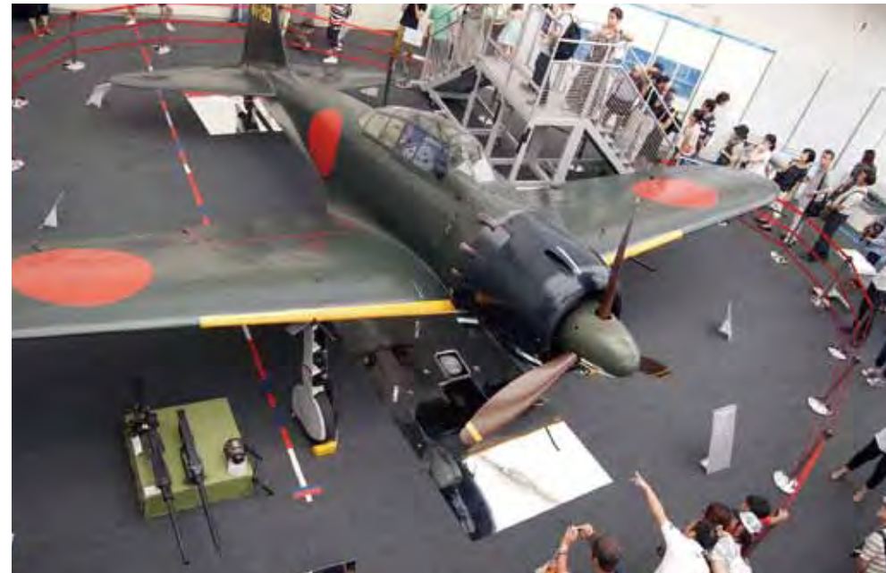
海軍零式艦上戦闘機五二型の実物 □全幅11m □全長9.1m □航続距離1,920km (所沢航空発祥記念館)
