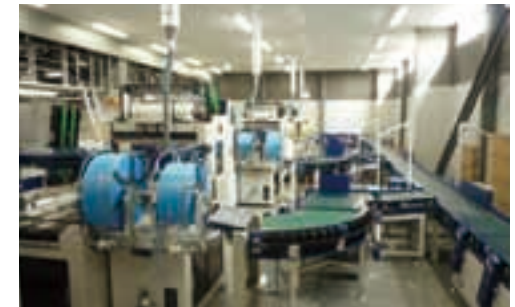
印刷された新聞は自動で梱包され配達のトラックに積み込まれます
